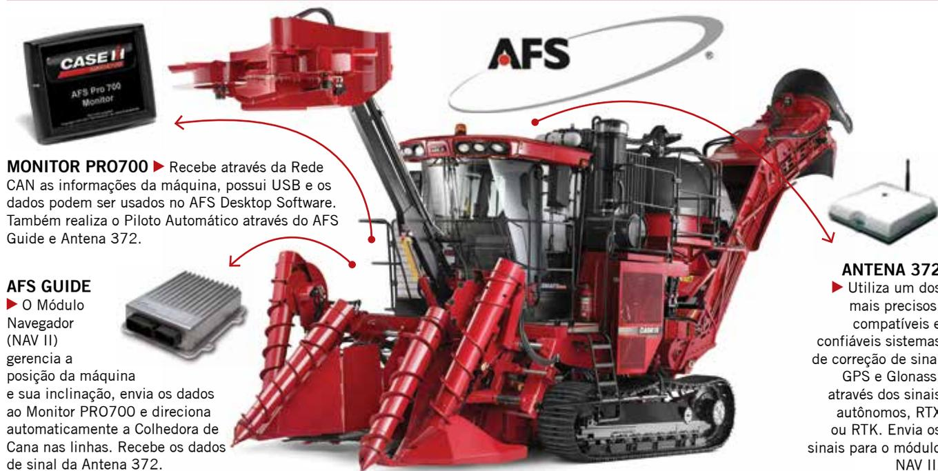
**MONITOR PRO700** ▶ Recebe através da Rede CAN as informações da máquina, possui USB e os dados podem ser usados no AFS Desktop Software. Também realiza o Piloto Automático através do AFS Guide e Antena 372.
