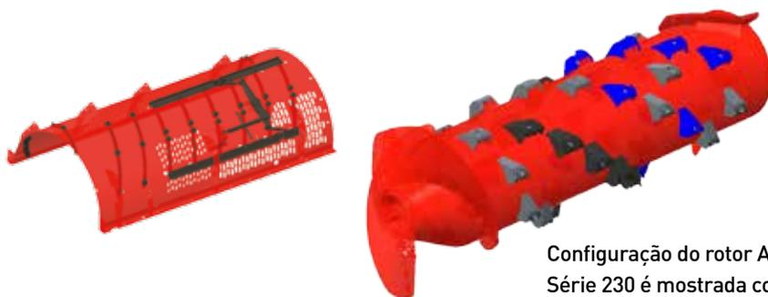
Configuração do rotor AFX da Axial-Flow Série 230 é mostrada com barras retas.
