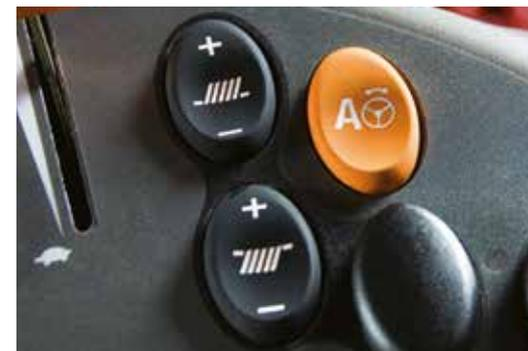
O ajuste de peneira a partir da cabine vem como item padrão na Axial-Flow Série 230. Ele permite o ajuste fino das peneiras sem que o operador tenha de sair de seu assento.
