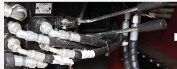
Alavancas para ajuste da distância dos cilindros derrçadores
