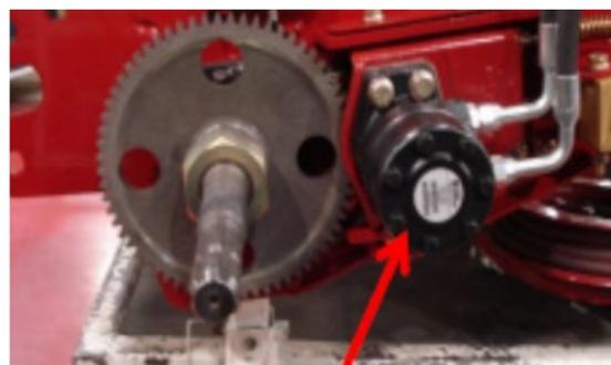
Acionamento eletro-hidráulico de reversão – Motor hidráulico
