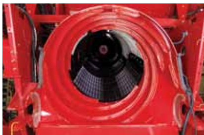
▲ Cone de transição temperado e côncavo com barras temperadas.
