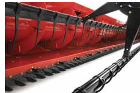
▲ Plataforma de grãos: sem-fim de maior diâmetro, com dedos retráteis em toda a sua extensão.
