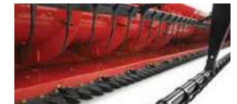
Cabezal de grano: sin fin de mayor diámetro, con Dedos retráctiles en toda la longitud
