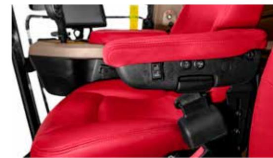
Asiento de suspensión neumática o asiento de piel semiactivo, calefactado y ventilado con controles para proporcionar un nivel de confort de lujo como en un automóvil
