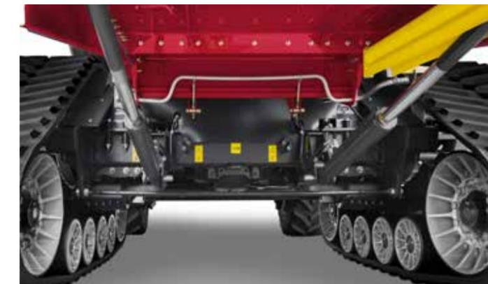
Reposicionamiento de los cilindros de elevación para una mayor capacidad de elevación. Dobles cilindros de elevación para un mejor control de altura del cabezal
