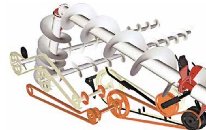
Los accionamientos independientes para los sinfines de descarga vertical y horizontal y los sinfines transversales de la tolva garantizan el vaciado completo del sinfín de descarga
