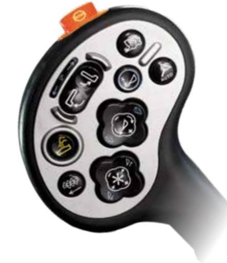
El Feedrate Control se maneja con solo pulsar un botón en la palanca multifunción
