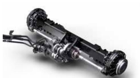
Nueva transmisión hidrostática para una mayor tracción. Los frenos refrigerados por aceite ofrecen una potencia de frenado constante
