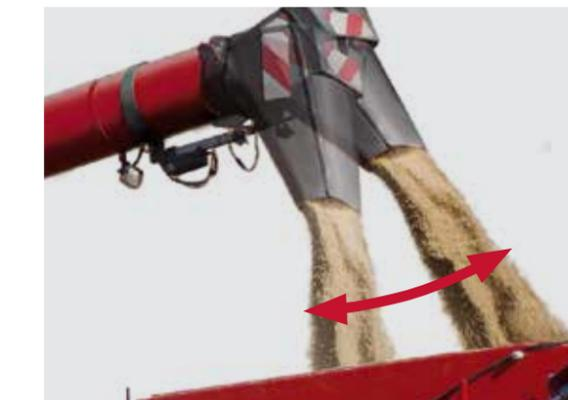
La boca pivotante de descarga se acciona con la palanca multifunción y dirige el flujo de grano hasta el interior del carro de grano, llenándolo hasta el nivel máximo sin derramarlo
