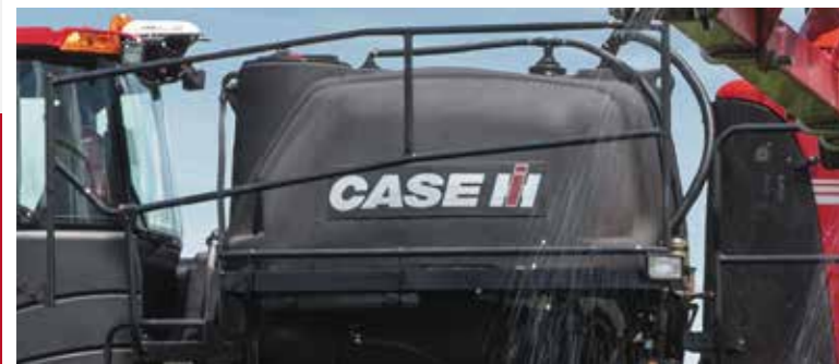
Tanque de producto
