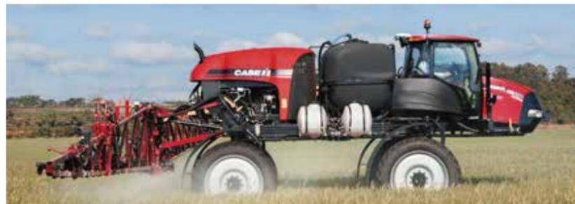
Sistema de inyección directa (opcional). Dos depósitos, cada uno con una capacidad de 100 l, eliminan la necesidad de mezclar productos químicos dentro del depósito principal. La inyección de producto desde estos depósitos se realiza directamente en la línea de la barra de pulverización. Esto facilita el proceso de reposición de producto a los agricultores, además de ahorrar en consumo y ofrecer la opción de utilizar productos que no se pueden mezclar.
