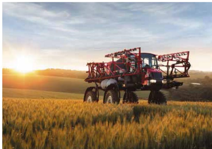
El motor FPT de Case IH situado en la parte trasera, la cabina en la parte delantera y el depósito de producto central proporcionan una distribución óptima del peso y una excelente estabilidad, así como una menor compactación del terreno.
