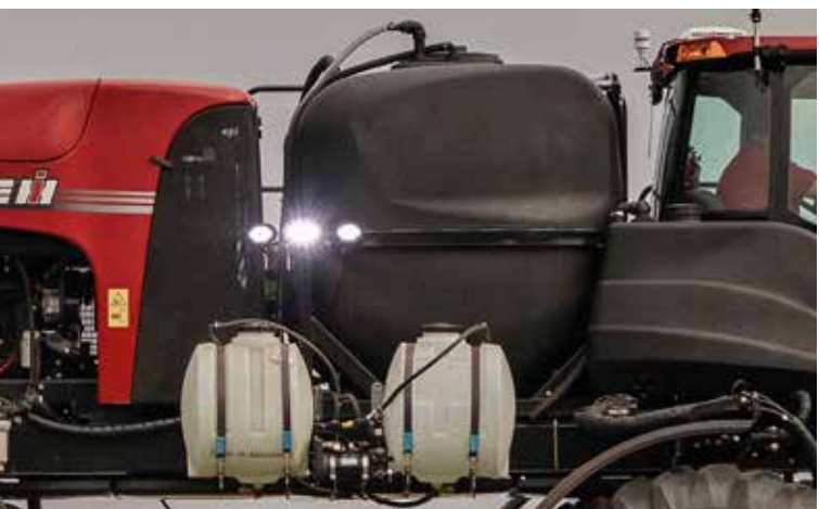
Tanque de produto
