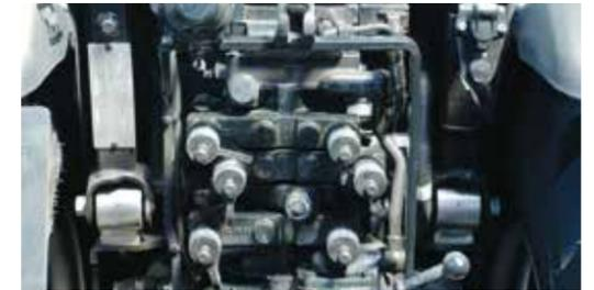
O controle de vazão para a primeira válvula remota pode ser ajustado facilmente
