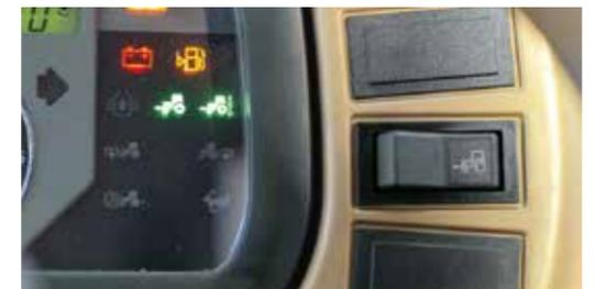
A tração 4x4 automática aciona e desativa automaticamente, por exemplo, em curvas fechadas, ao frear e dependendo da velocidade de avanço
