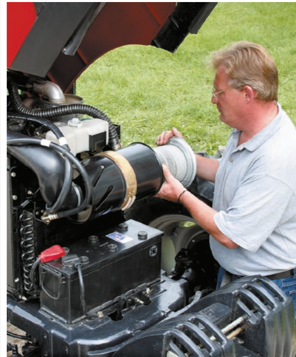
El filtro puede ser quitado sin necesidad de herramientas, volviendo el mantenimiento más rápido.
