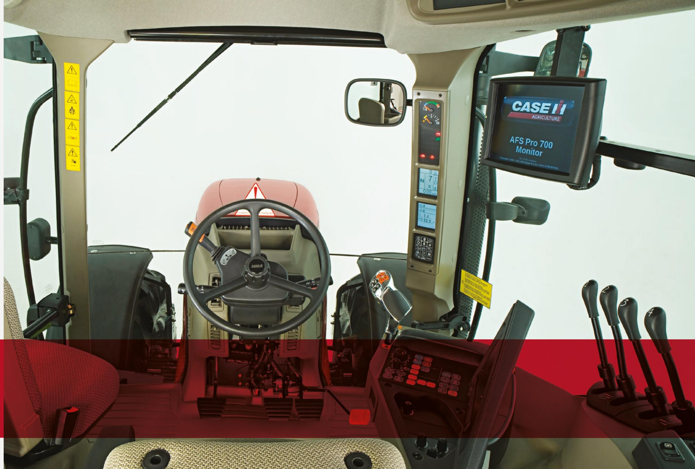
El reposabrazos multifuncional está diseñado para encajar perfectamente en la mano derecha del operador, lo que le proporciona una comodidad total en el funcionamiento del tractor y el acceso a las principales funciones operativas.
