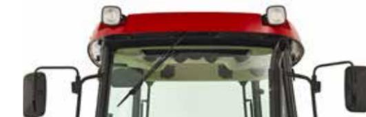
▲ Até quatro faróis de serviço ajustáveis podem ser instalados na cabine para melhorar a visibilidade noturna.
