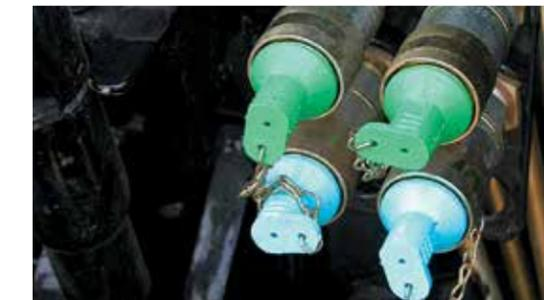
▲ O sistema auxiliar de válvula remota oferece duas válvulas traseiras.
