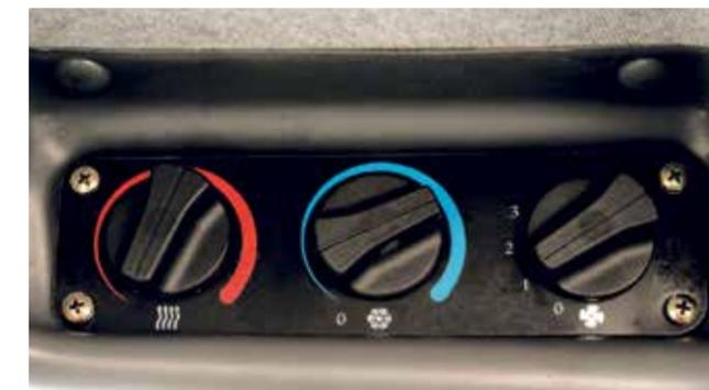
O interior espaçoso da cabine, com o ar-condicionado, proporciona ao agricultor excelente climatização. Os controles climáticos estão favoravelmente instalados no teto da cabine. Além disso, todas as cabines saem de fábrica com carvão ativo, sendo este recomendado para operações de pulverização.
