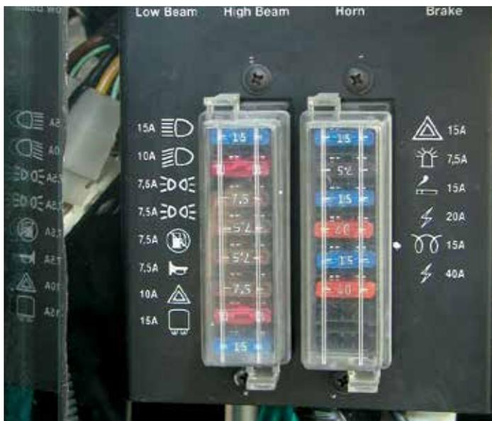
◀ Todos os fusíveis são do tipo automotivo e facilmente identificáveis para tornar mais fácil a detecção de defeitos e a sua substituição.
