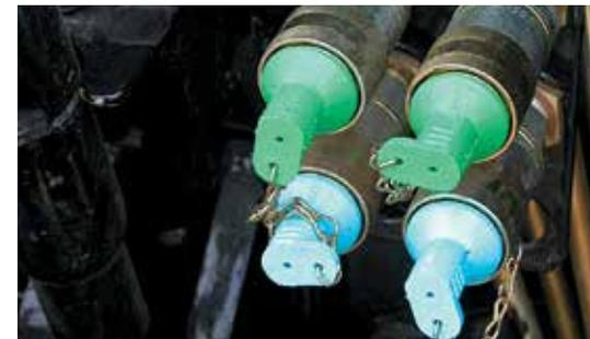
▲ O sistema auxiliar de válvula remota oferece duas válvulas traseiras.
