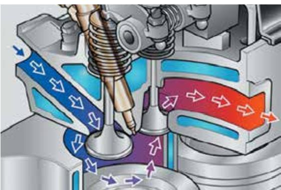
▲ O projeto do cabeçote do cilindro "CrossFlow" permite a redução do consumo de combustível. O modelo Farmall 95 vem equipado com motor turboalimentado, o que aumenta ainda mais o desempenho.
