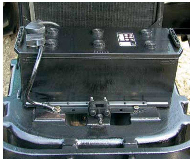
▲ A bateria é montada debaixo do capô do motor, na parte dianteira do trator.
