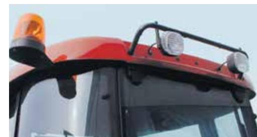
▲ Até quatro faróis de serviço ajustáveis podem ser instalados na cabine para melhorar a visibilidade noturna.
