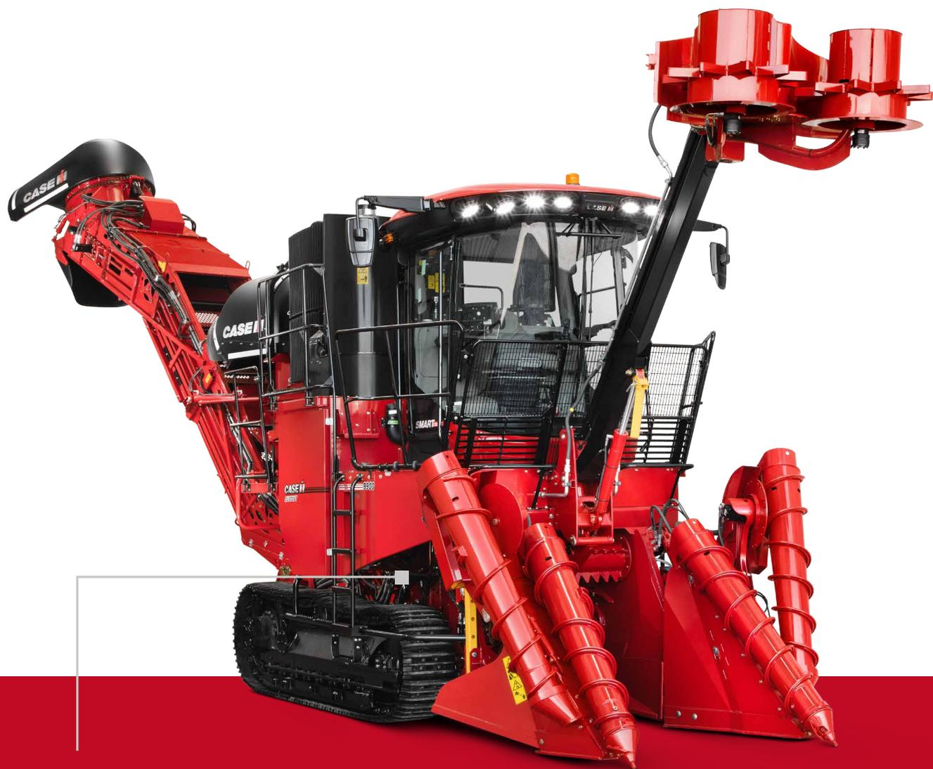
Cilindro de suspensión repositionado mas adelante de la cosechadora haciendo que el sistema AutoTracker sea aún más eficiente y con menos tiempo de respuesta a la orden de elevación de la suspensión.
