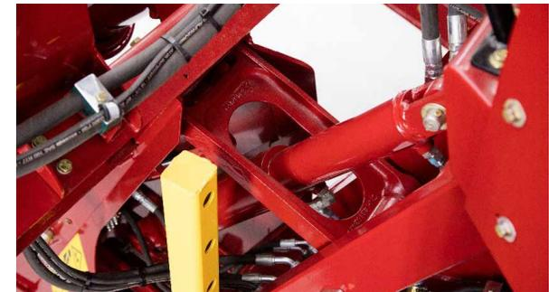
Bandejas de los divisores, soporte de los discos de corte laterales y mesa de giro del elevador, construidas en hierro fundido nodular.
