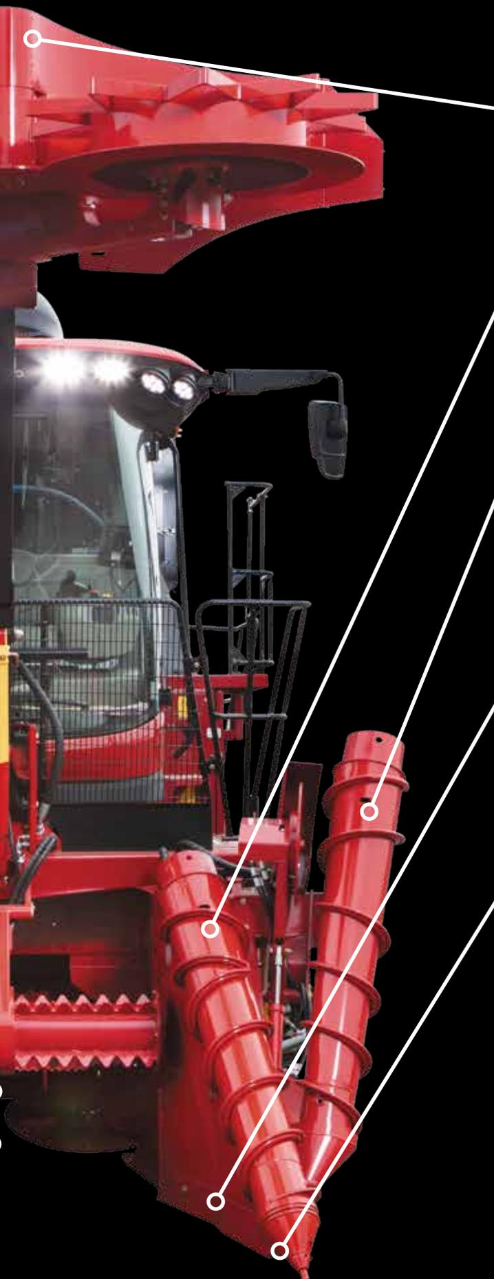
**Despuntador de mayor dimensión**, o para despunte de las 2 líneas de caña, con ajuste de altura y dirección de descarte de los desechos, que permite la eliminación de impureza vegetal y mejora la calidad de la caña cosechada.
