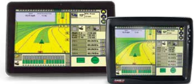
Les moniteurs XCN-2050 et FM-1000 dans le tracteur communiquent de l'information d'aide au système TrueTracker, en fournissant une précision constante pour améliorer la couche de semis et le placement de nutriments, permettant ainsi d'améliorer la récolte et les rendements.
