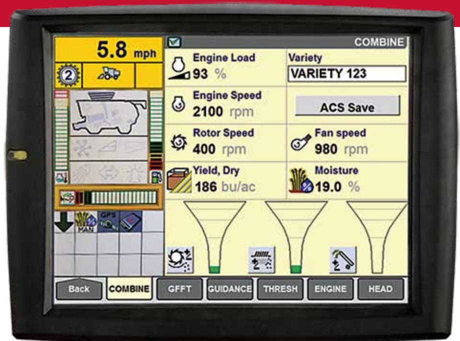
Le moniteur AFS Pro 700 permet de voir six écrans à la fois, ce qui vous permet de contrôler les fonctions clés de la machine.
