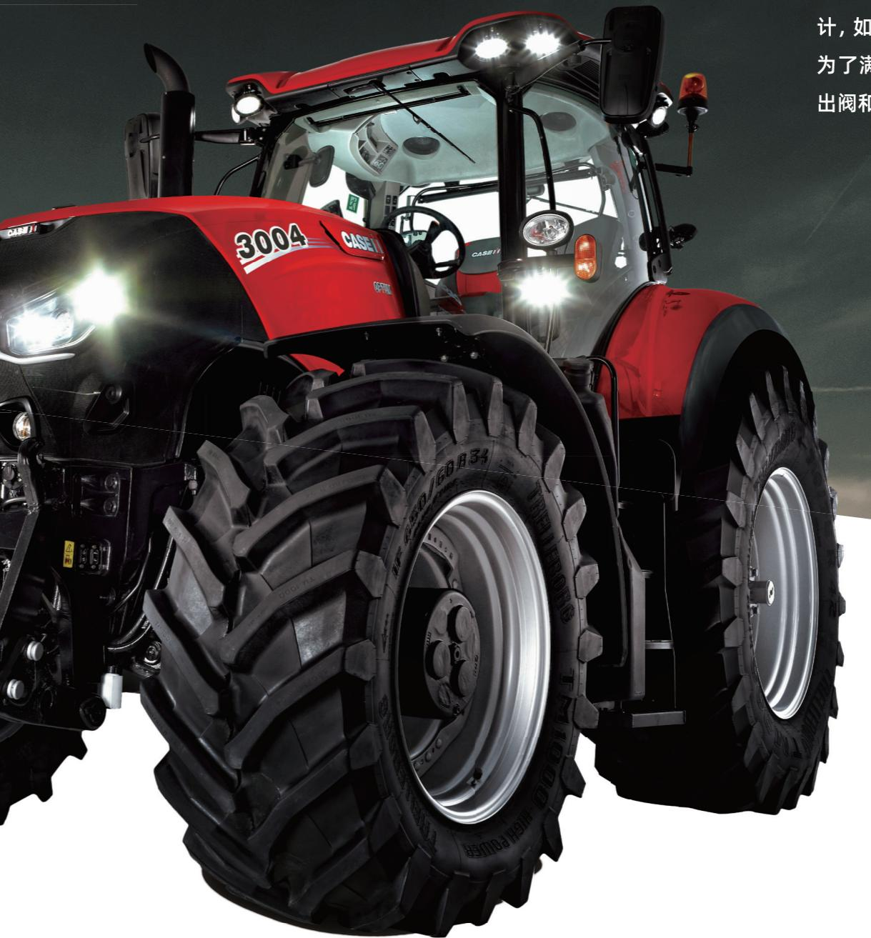
凯斯 OPTUM CVXDRIVE 系列拖拉机的结构尺寸和重量是目前国内同马力段功能性最强的拖拉机。这一系列的拖拉机专门针对中大型客户设计，如翻地、深松等。无极变速变速箱更是可以使燃油经济性发挥到极致。为了满足客户对于复试作业的需求，整机可以选配前动力输出、远程输出阀和前悬挂，可以应用于如三联割草、复试作业等多种作业领域。
