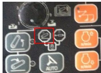
用三点悬挂装置运输设备时，在运输速度下，机具的跳动可能会导致转向难以控制。所以我们还应激活悬挂减震功能。按住控制面板上所示按键 2 秒，直到图标左上角的绿色指示灯亮起，以激活悬挂减震功能。
