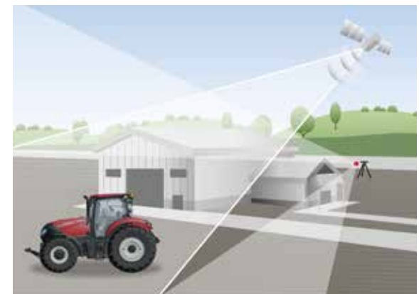
xFill überbrückt RTK+-Signalausfälle von bis zu 20 Minuten
