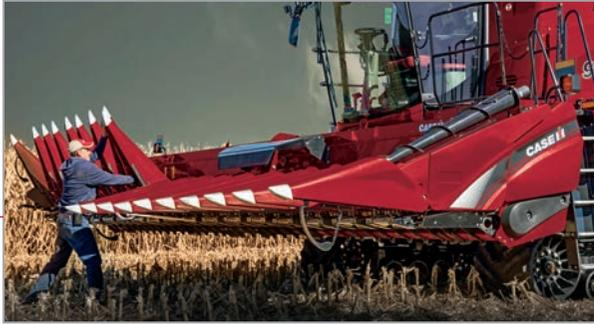
■ La série 4400 à écartement étroit a été conçue pour réduire le poids total et améliorer le centre de gravité. Cette caractéristique repose sur le maintien d'une robuste transmission par le biais des boîtes de vitesses (sans chaînes) et l'emploi de capots brevetés Case IH.
