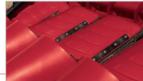
■ Grâce aux grilles **brevetées CornLouvers™**, le moindre grain est ramené vers la vis de vidange et déchargé dans la moissonneuse-batteuse.
