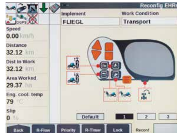
Le funzioni ISOBUS possono essere configurate sui dispositivi di controllo esistenti come il Multicontroller, il joystick e le leve di comando.
