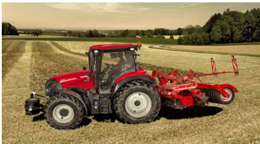
Svolte a fine campo completamente automatiche con il sistema AFS AccuTurn
