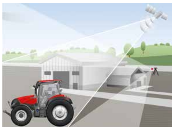
L'app xFill assicura fino a 20 minuti di connettività di bridging per il mantenimento, in caso di perdita, del segnale RTK +
