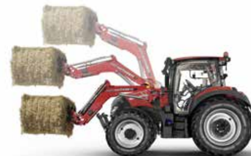
Caricatore frontale con guida parallela meccanica
