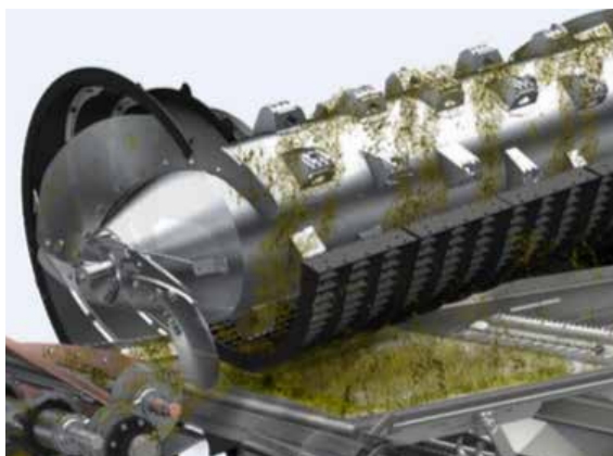
Kąt opasania klepisk młocarni wynosi 180°
