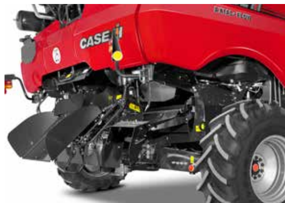
Rozrzutnik słomy z różnymi trybami rozkładania resztek poźniwnych na szerokości do 14 m
