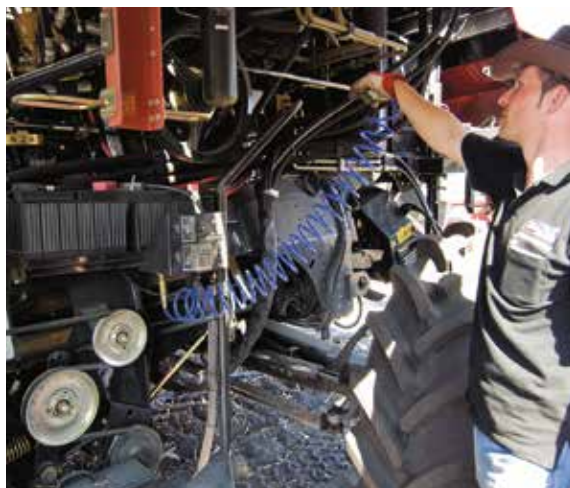
Codziennie kontrole i czyszczenie zostały ułatwione dzięki nowemu odchylanemu zespołowi chłodnic, natomiast filtr powietrza znajduje się w miejscu ułatwiającym szybką kontrolę
