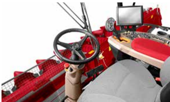
Składana kolumna kierownicy z nowym wyłącznikiem awaryjnym oraz wysuwana kierownica zapewniają nieograniczone pole widzenia.
