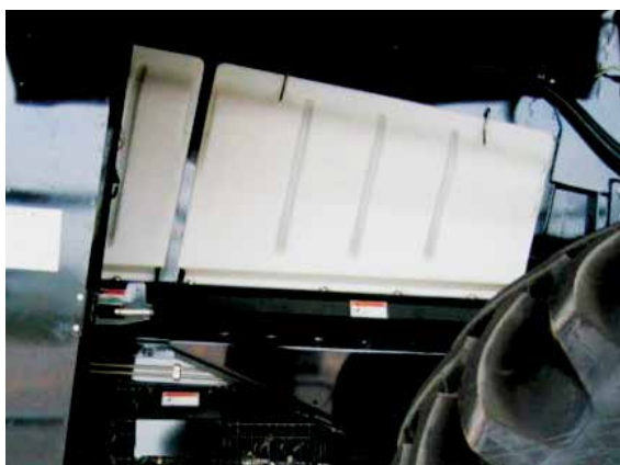
Wyśmienity dostęp do maszyny w celu prowadzenia konserwacji po zdemontowaniu białych osłon wytłoczonych z tworzywa sztucznego
