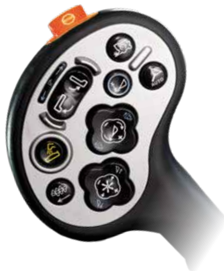
Prędkość podawania masy żniwnej można regulować za pomocą przycisku na wielofunkcyjnej dźwigni sterowania
