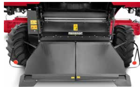
System rozdrabniania X-tra Chopping z niezależnymi płytami rozrzutnika
