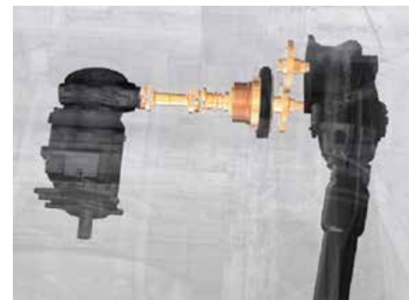
Kompaktowy napęd rotora bez użycia pasów z trójbiegową skrzynią biegów umożliwiającą wolną jazdę przy żniwach delikatnych roślin
