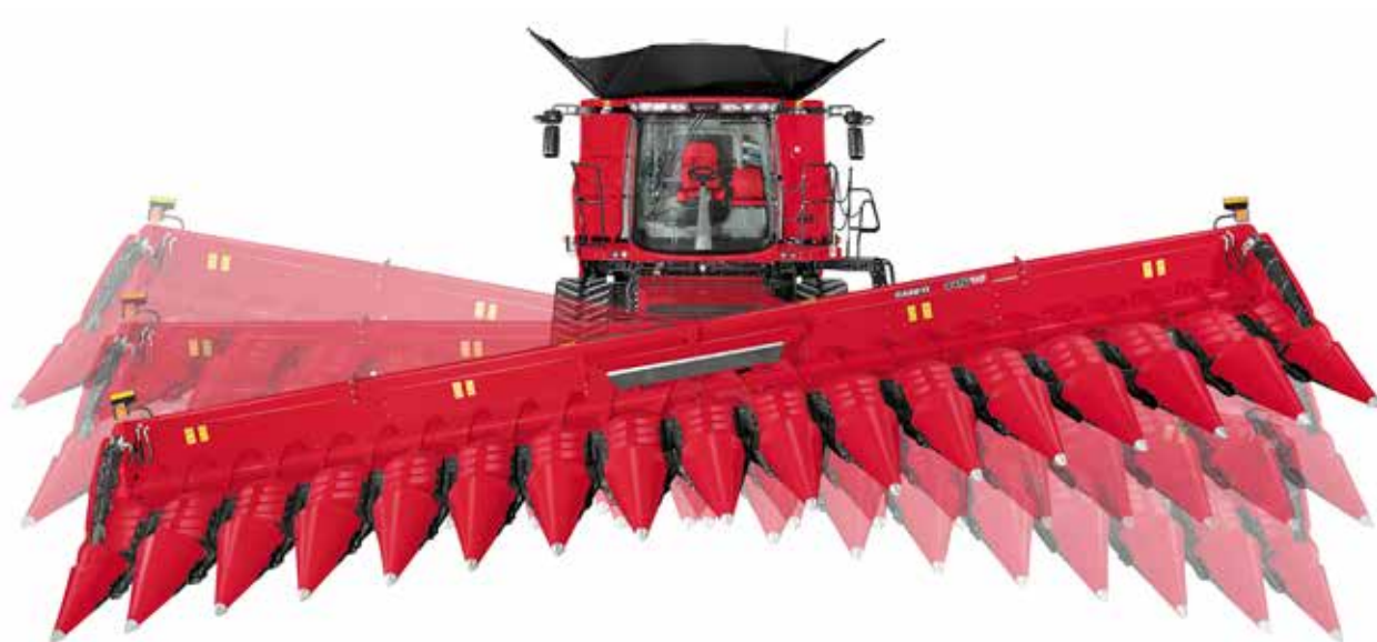
Stosowany przez Case IH system kopiowania terenu zapewnia utrzymywanie zadanej wysokości koszenia nawet na najbardziej nierównym terenie.
