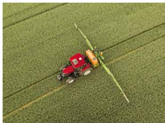
AFS AccuGuide: Prowadzenie maszyn przy pomocy systemów GPS i GLONASS
