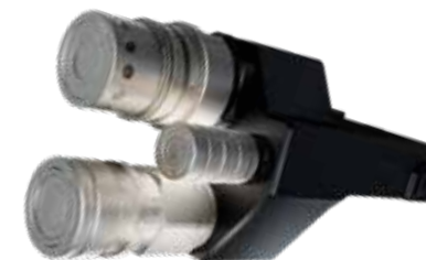
Silniki olejowe lub osprzęt, które potrafią stanowić dla układu hydraulicznego wyzwanie, mogą być obsługiwane przez pompę o wydatku 110 l/min, do której podłączone jest za złącze Power Beyond.
