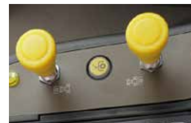
Elektrohydrauliczne aktywowanie der Heck- und Frontzapfwelle.
