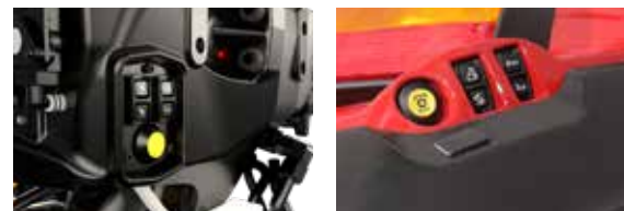
Zewnętrzne elementy sterowania znajdują się zarówno z przodu i z tyłu ciągnika i służą do regulacji podnośników hydraulicznych, WOM-u oraz dodatkowej jednostki sterującej.
