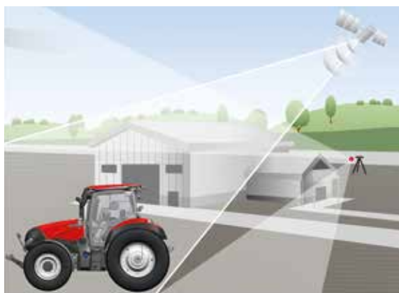
xFill pokrywa nawet 20-minutowe przerwy w odbiorze sygnału RTK+
