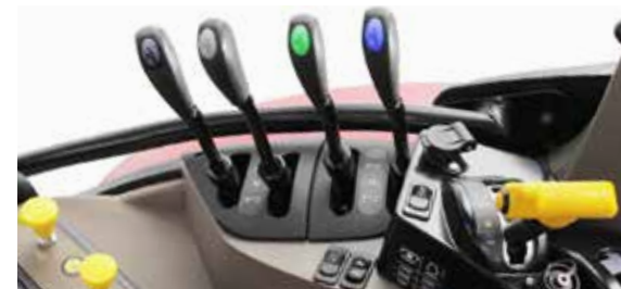
Modele wyposażone wyłącznie w mechaniczne tylne zawory hydrauliki zewnętrznej są również proste w obsłudze za pomocą ergonomicznych dźwigni.
