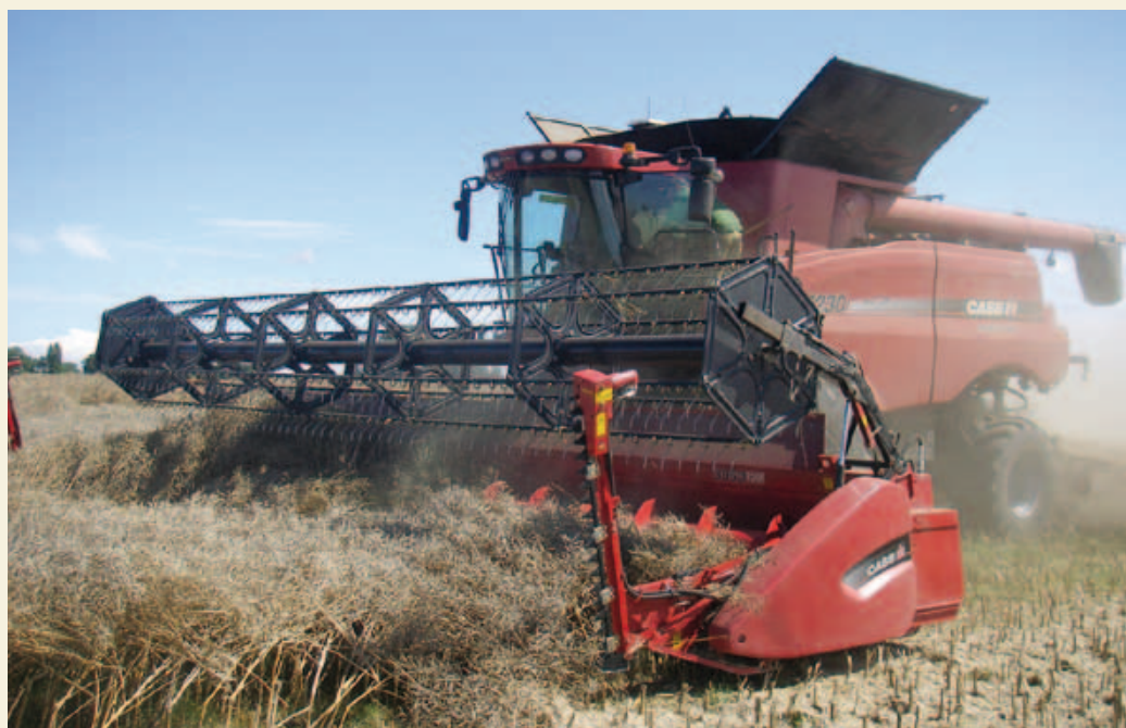
Høst af vinterraps på roden med sideknive monteret går nemt med lavt spild.
