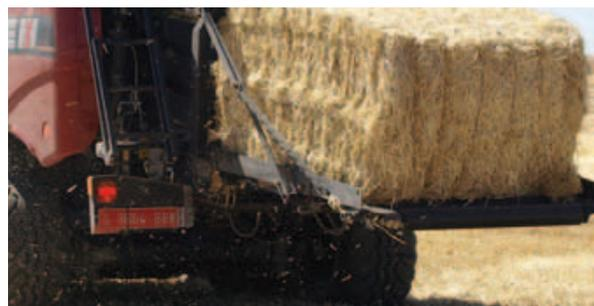
Una paca a punto de ser soltada, ocupando toda la rampa de descarga de la máquina.
