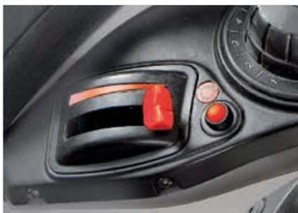
Im Eco-Modus wird die Höchstgeschwindigkeit von 40 km/h bei reduzierter Drehzahl (1.750 U/min) erreicht, was zu deutlichen Kraftstoffersparnissen führt.
