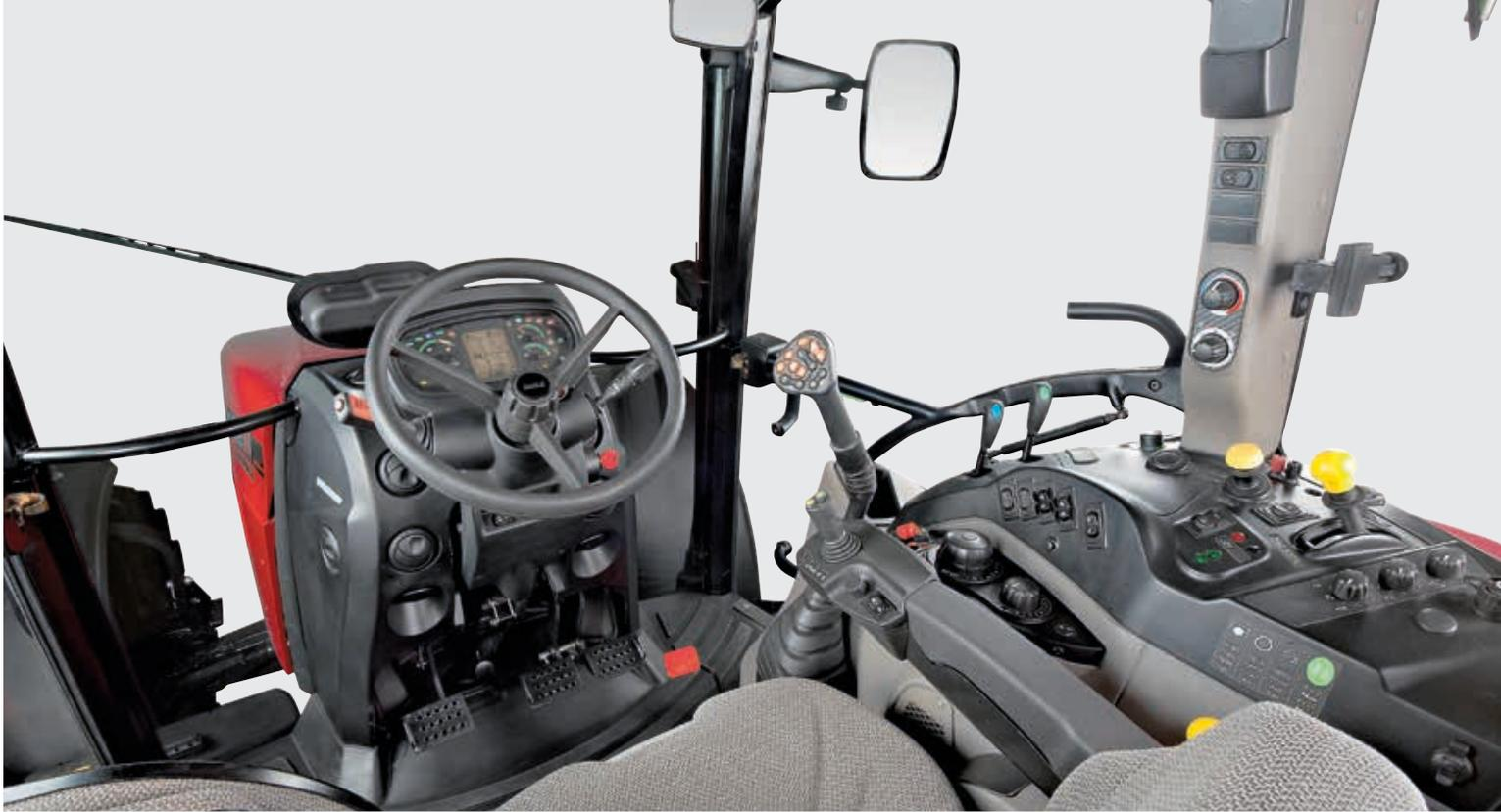
Zudem können über einen neu entwickelten Joystick die elektrohydraulischen Funktionen (auch eine mechanische Funktion ist verfügbar) sehr feinfühlig bedient werden. Damit werden insbesondere bei dem Betrieb mit einem Frontlader neue Standards gesetzt.
