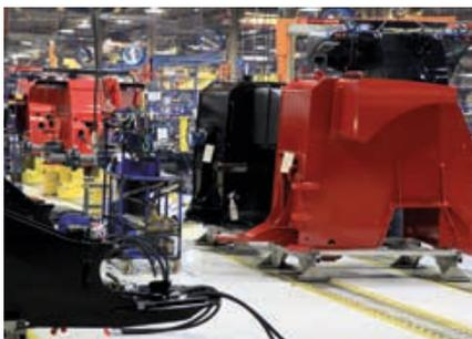
**7** Nach dem Lackieren auf's Fließband: Hier warten weitere Bauteile darauf, mit dem Chassis verbunden zu werden. Übrigens wird in Fargo nur auf Bestellung gebaut, nicht auf Halde.
