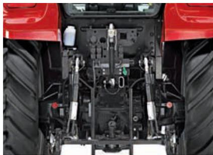
Der Farmall U Pro verfügt serienmäßig über eine Zapfwelle mit vier Geschwindigkeiten bei einer Motor-Drehzahl von 1.900 U/min (Eco-Modus 1.600 U/min), die für den Kraftstoffsparenden Antrieb von zapfwellengetriebenen Geräten wie etwa Pressen ideal ist und dabei über die volle Kraft des Motors verfügt.
