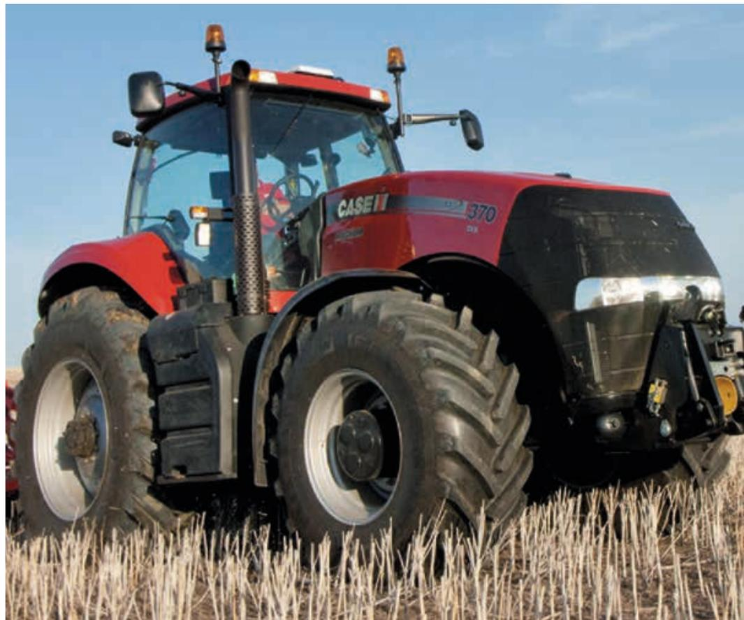
Insgesamt stehen bis zu sechs elektrische Steuergeräte mit Mengen- und Zeitsteuerung in beide Richtungen zur Verfügung. Das Fronthubwerk besitzt bei der neuesten Magnum Generation eine Hubkraft von fünf Tonnen. Am Heck hebt der Magnum problemlos mehr als elf Tonnen.
