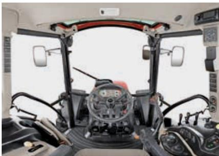
Das neue, innovative Kabinenkonzept sorgt für eine geringere Aufheizung der Kabine bei warmer Witterung und für optimale Geräuschdämmung. Das Klimatisierungskonzept wurde für eine angenehme und zugfreie Belüftung so optimiert, dass kein Lüftungseingang oberhalb des Armaturenbretts liegt. Insgesamt sorgen 10 Lüftungsdüsen für optimale Belüftung.
