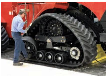
**10** Am Ende des Bandes werden die jeweils über 200 kg schweren Ketten aufgezogen. Beim Motorstart werden sie automatisch gespannt.
