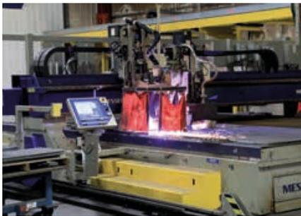
**4** Ein Blick auf die moderne Laserschneid-anlage. Hier werden nicht nur Teile für Traktoren, sondern auch für Radlader ausgeschnitten.
