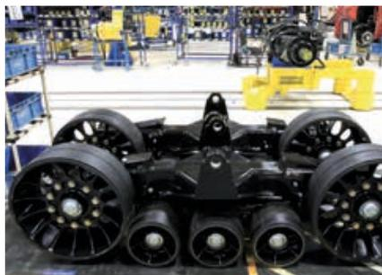
**8** Der untere Teil des Fahrwerks ist fertig: Die mittigen Laufrollen und die äußeren Umlenrollen bilden eine flexible Einheit.
