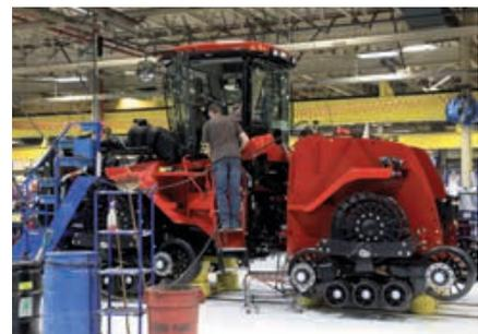
**9** Mit dem Verbinden von Vorder- und Hinterwagen, dem Einsetzen des Motors und dem Aufsetzen der Kabine nimmt der gesamte Traktor nun langsam seine bekannte Form an.
