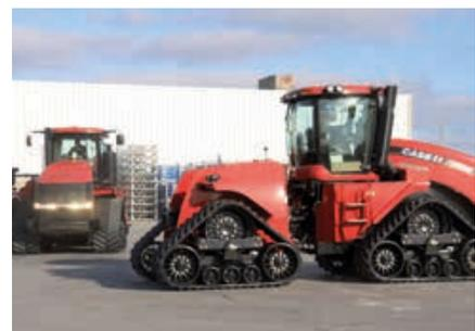
**12** Probefahren vor der Fabrik: Getriebe, Fahrwerk und Lenkung werden gecheckt. Außerdem achten die Fahrer auf unerwünschte Nebengeräusche oder Vibrationen.
