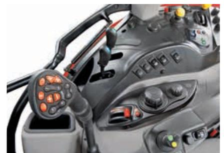
Wie bei den großen Traktoren: Um den Multicontroller-Ganghebel herum ist das bewährte Efficient Power Bedienkonzept zu finden. Alle wichtigen Funktionen können über den Multicontroller bedient werden, darunter Heckhydraulik, Powershuttle und Powerclutch, vier Lastschaltstufen mit Automatikfunktion und zwei unterschiedliche Motordrehzahlen sowie elektronische Steuergeräte.
