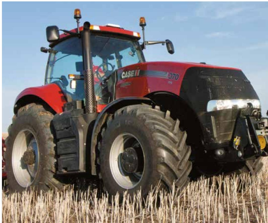
litros por minuto y hasta seis distribuidores electrónicos con control de caudal, así como con contadores de tiempo para ambas direcciones. El enganche delantero en la última generación Magnum ofrece una capacidad de elevación de cinco toneladas. Con el extremo posterior, el Magnum levanta más de once toneladas sin esfuerzo.
