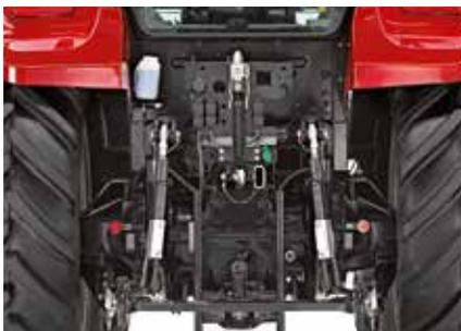
El Farmall U Pro también está equipado con una TDF estándar de cuatro velocidades, con una velocidad del motor de 1.900 rpm (1.600 rpm en modo Eco), ideal para garantizar el ahorro de combustible en aquellas máquinas accionadas mediante TDF, como por ejemplo las empacadoras, conservando a la vez toda la potencia.
