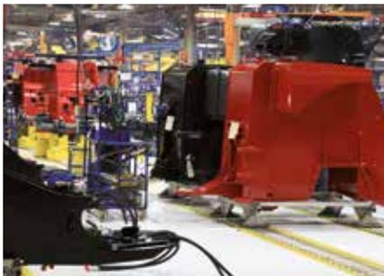
**7** Una vez pintadas, las piezas van a la línea de montaje. Allí ya hay otros componentes esperando para ser montados sobre el chasis. Por cierto, en Fargo todo se hace por encargo.
