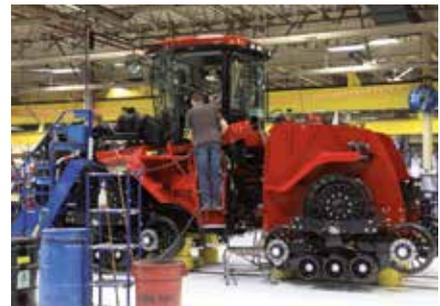
**9** Aquí se unen el chasis delantero y el trasero, se instala el motor y se coloca la cabina; poco a poco el tractor va tomando forma.
