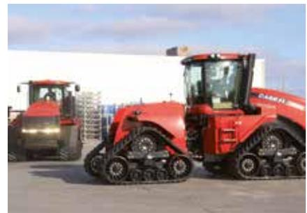
**12** Prueba de conducción in-situ: se comprueba la transmisión, el chasis y la dirección. Los conductores también están atentos a ruidos extraños y vibraciones.
