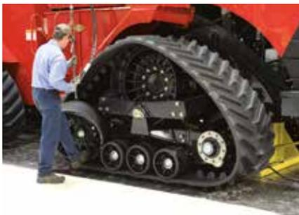
**10** Las orugas pesan más de 200 kg y se colocan al final de la línea. Se tensan automáticamente al arrancar el motor ...
