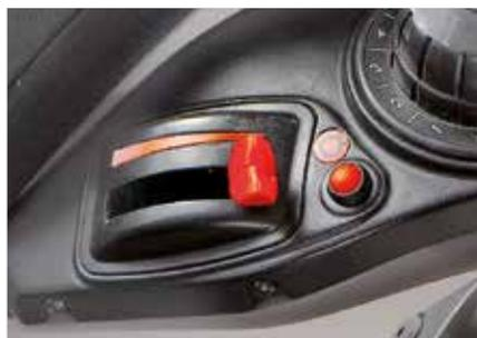
En modo Eco, el tractor alcanza una velocidad de 40 Km/h a bajas revoluciones del motor (1750 rpm), lo que contribuye a un importante ahorro de combustible.
