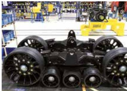
**8** La sección inferior del chasis ya está terminada: las roldanas centrales y las roldanas exteriores de guía forman una unidad flexible.
