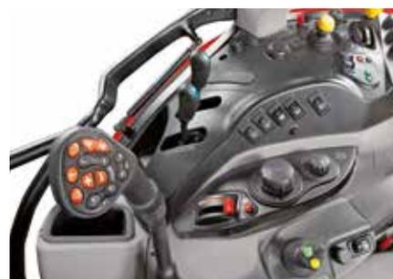
Igual que en los tractores grandes: el concepto Efficient Power parte de la palanca Multicontroller. Todas las funciones clave se pueden activar con el Multicontroller, incluyendo el enganche posterior, el inversor y el embrague, cuatro cambios de marcha, dos velocidades de motor y los distribuidores.
