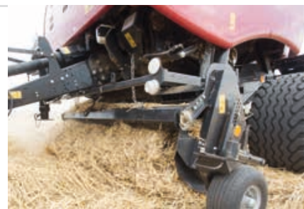
Die fünfbalkige Pickup nimmt auch sehr kurzes Erntegut bei hohen Geschwindigkeiten verlässlich auf.
