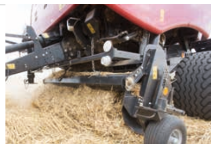
Med fem rækker fjederholdere i pickuppen opsamles selv meget korte strå effektivt selv ved høj hastighed.
