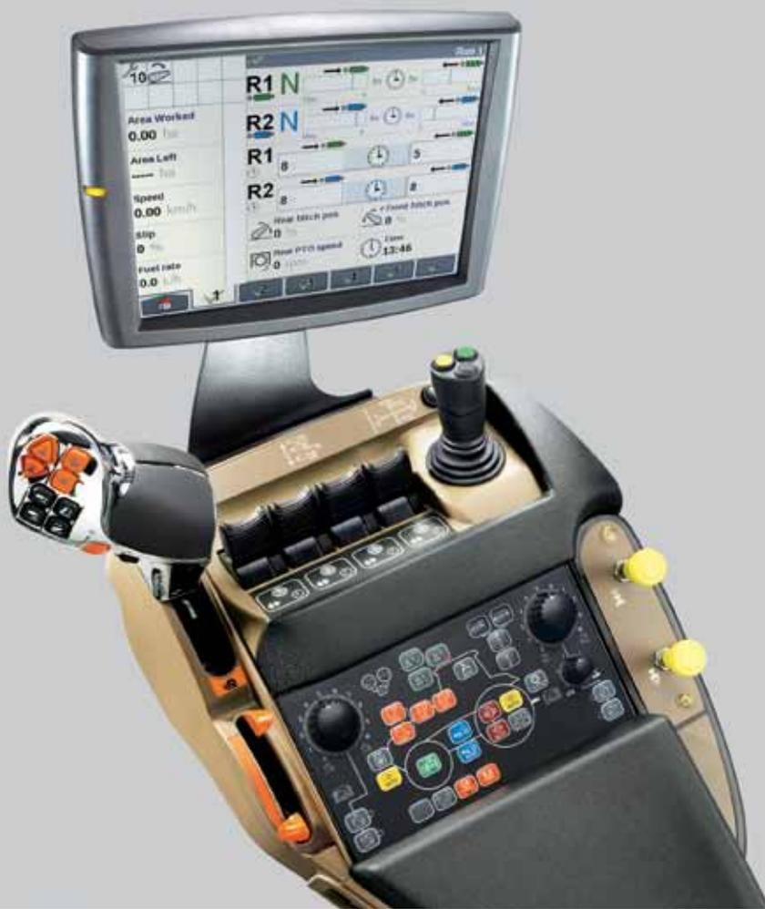
Poignée Multicontroller avec panneau ICP et commande EcoDrive du Puma CVX
