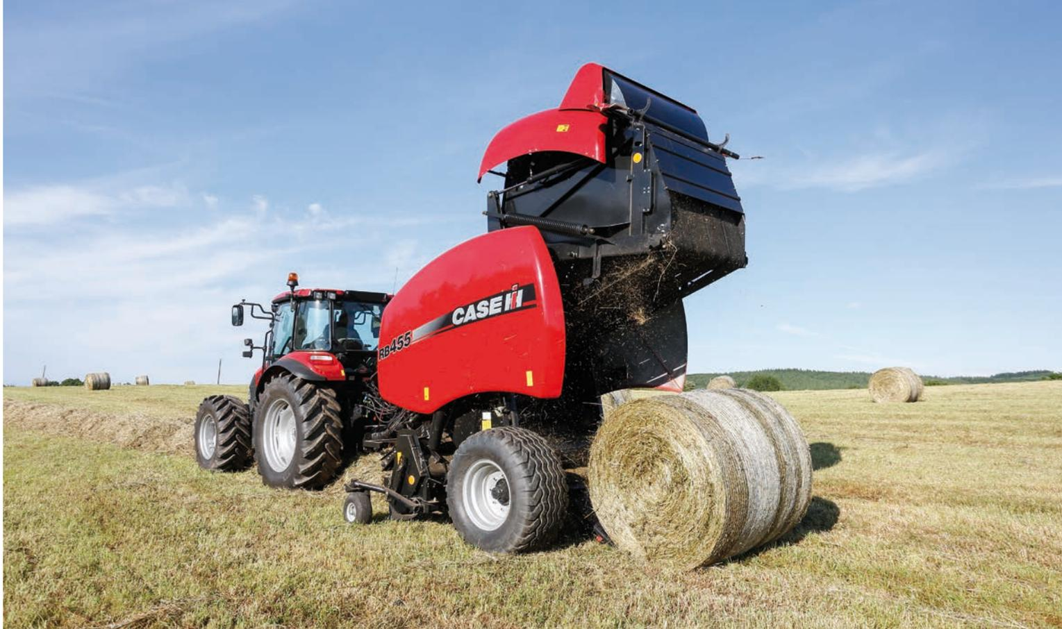
et gauche) pour maximiser la densité en paille sèche par exemple. La formation de la balle débute par "un noyau mou" pour une conservation optimale.
