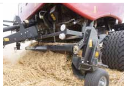
Podbieracz z pięcioma belkami palcowymi niezawodnie zbiera nawet bardzo krótkie rośliny przy dużej prędkości przejazdu.
