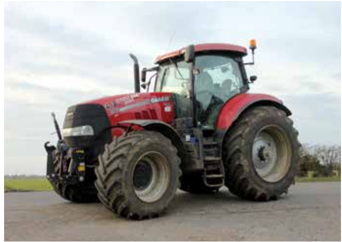
La vitesse maximale de 50 km/h est également atteinte avec des remorques, à un régime moteur de 1 500 tours/min seulement. C'est l'un des principaux avantages de la transmission CVX.
