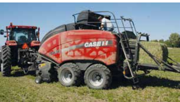
La presse à balles LB 434 offre un accès facile lors de la maintenance, notamment grâce à une échelle repliable solide située en haut de la presse à balles et de grandes trappes de maintenance faciles à ouvrir. La presse à balles peut emmagasiner jusqu'à 16 balles doubles de part et d'autre.
