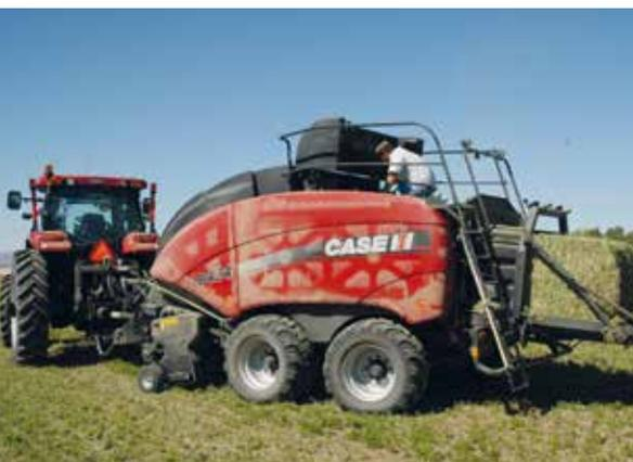
Die Ballenpresse LB 434 ermöglicht einen einfachen Zugang für die Wartung, u. a. eine robuste Klappleiter oben auf der Ballenpresse und große, leicht zu öffnende Wartungstüren. Die Ballenpresse kann an jeder Seite 16 Doppelballen aufnehmen.
