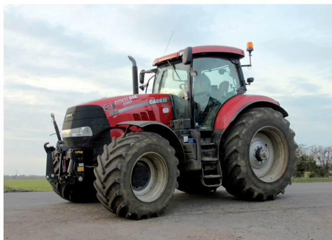
La velocità massima di 50 km/h viene raggiunta, anche in caso di traino di un rimorchio, a soli 1.500 giri/min. Questo è un notevole vantaggio del cambio CVX.
