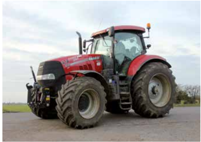
De maximumsnelheid van 50 km/h wordt ook bij gebruik met een aanhangwagen bereikt bij een toerental van slechts 1500 omw/min – een groot voordeel van de CVX-transmissie.
