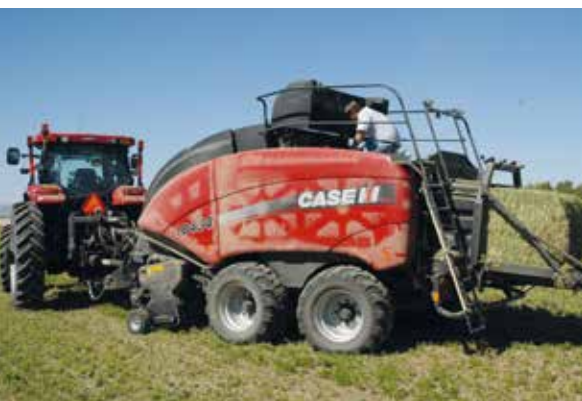
De balenpers LB 434 maakt een eenvoudige toegang voor het onderhoud mogelijk, o.a. via een robuuste opvouwbare ladder bovenop de balenpers en grote, eenvoudig te openen onderhoudsdeuren. De balenpers kan aan elke zijde 16 dubbele balen opnemen.
