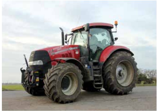
Die Höchstgeschwindigkeit von 50 km/h wird auch im Anhängerbetrieb bei nur 1.500 U/min erreicht – ein großer Vorteil des CVX-Getriebes.
