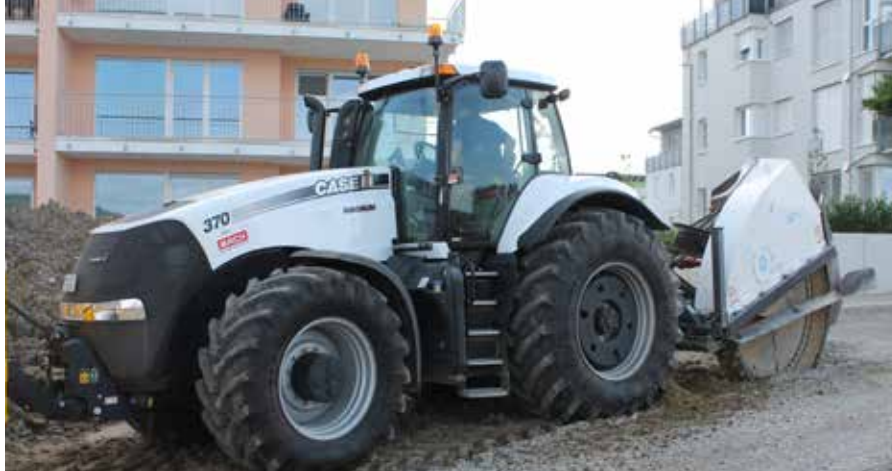
In der Praxis sehr geschätzt: der neue Magnum 370 CVX in Baustellenausführung. Die Anwender schätzen vor allem die hohe Leistung des Magnum CVX, beispielsweise beim Antrieb von Spezialgeräten.
