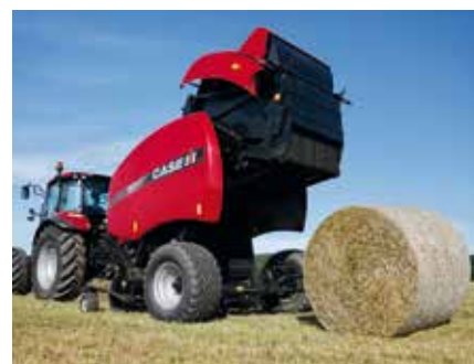
Die fünfreihige Pickup nimmt auch sehr kurzes Erntegut bei hohen Geschwindigkeiten verlässlich auf.
