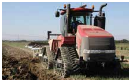
Im Ackerbau der Genossenschaft werden zwei Quadtracs vom Typ 535 und 550 eingesetzt. Durch den Einsatz der Quadtracs konnten die Kosten der Grundbodenbearbeitung erheblich gesenkt werden.
