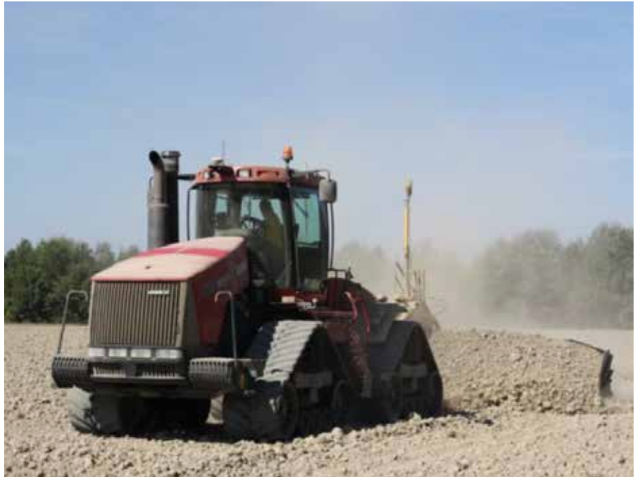
Ein weiterer Vorteil des Quadtracs: Der Verschleiß der Ketten ist erheblich niedriger als bei Reifen, vor allem, wenn die Böden nach einem warmen und trockenen Sommer hart sind.
