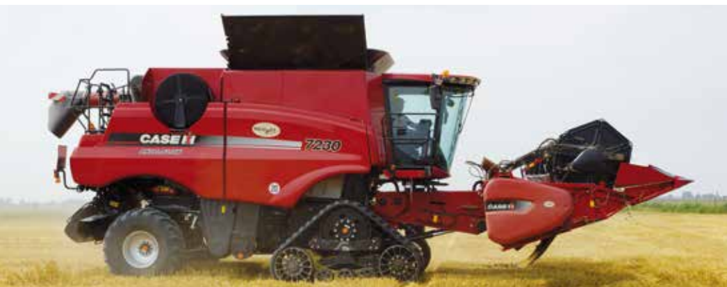
Nicht nur sanft auf dem Acker. Trotz der hohen Aufstandsfläche des Trac-Laufwerks liegt die Außenbreite bei 3,49 Metern. Damit kann der Mähdrescher straßenverkehrsordnungskonform eingesetzt werden.
