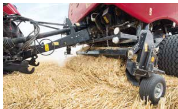
Die fünfreihige Pickup nimmt auch sehr kurzes Erntegut bei hohen Geschwindigkeiten verlässlich auf.
