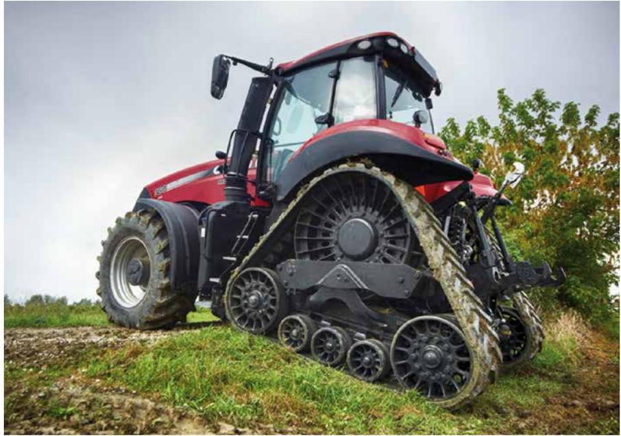
Fort de son expérience avec les chenilles sur le Quadtrac® et sur les Axial-Flow®, Case IH propose désormais le concept sur le Magnum™ afin de répondre aux attentes de ses clients en termes de capacité de traction et de faible impact au sol.
