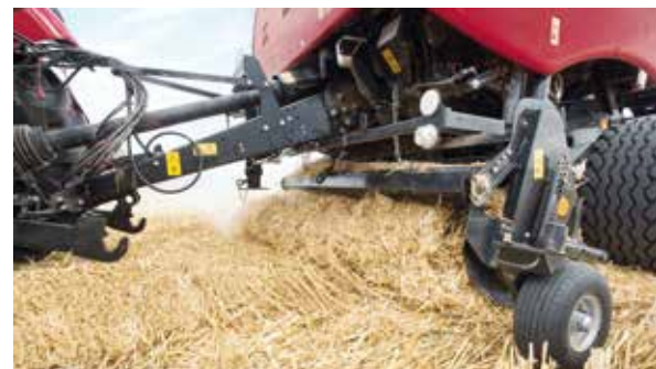
De pick-up met vijf rijen raapt ook bij hoge snelheden kort gesneden oogstgoed betrouwbaar op.
