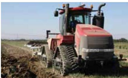
Im Ackerbau der Genossenschaft werden zwei Quadtracs vom Typ 535 und 550 eingesetzt. Durch den Einsatz der Quadtracs konnten die Kosten der Grundbodenbearbeitung erheblich gesenkt werden.
