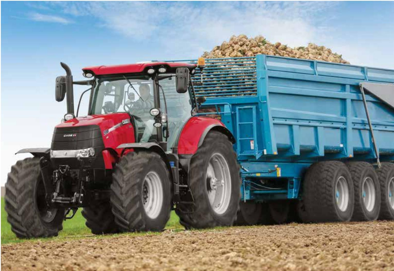
Les nouveaux tracteurs Puma révèlent une caractéristique exceptionnelle : des moteurs six cylindres à la fois puissants et économes en carburant. Ils sont en effet équipés de moteurs NEF 6,7 litres conçus par FPT Industrial. Le modèle supérieur, le Puma 240, bénéficie d'une puissance nominale de 240 ch.
