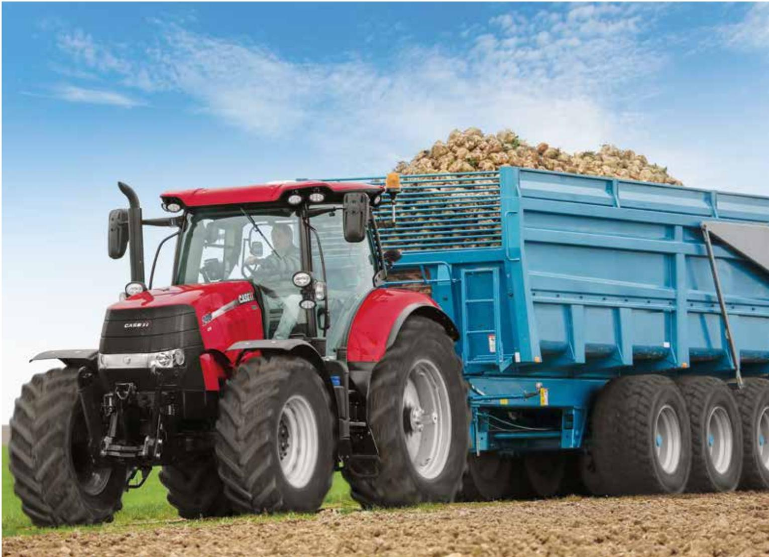
Oben: Ein Top-Merkmal der neuen Puma-Traktoren sind die leistungsstarken und kraftstoffsparenden Sechs-Zylinder-Motoren. Hier kommen 6,7 Liter NEF Motoren von FPT Industrial zum Einsatz. Das Spitzenmodell, der Puma 240, verfügt über eine Nennleistung von 240 PS.
