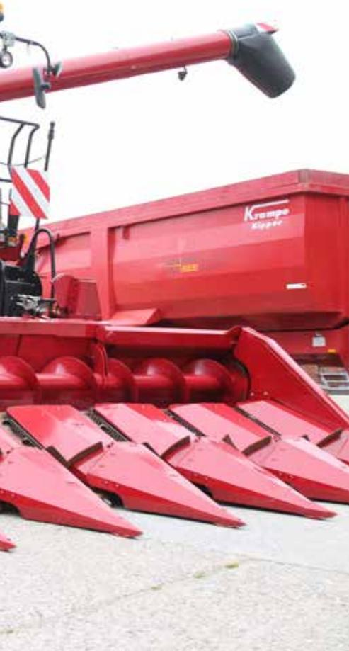
Rainer Uckelmann (links oben) hat sich jetzt mit der Dienstleistung zur Maisspindelernnte selbstständig gemacht. Der Mähdrescher ist mit einem Maispflückervorsatz ausgestattet, hinten der hochgeklappte Spindel-Bunker.
