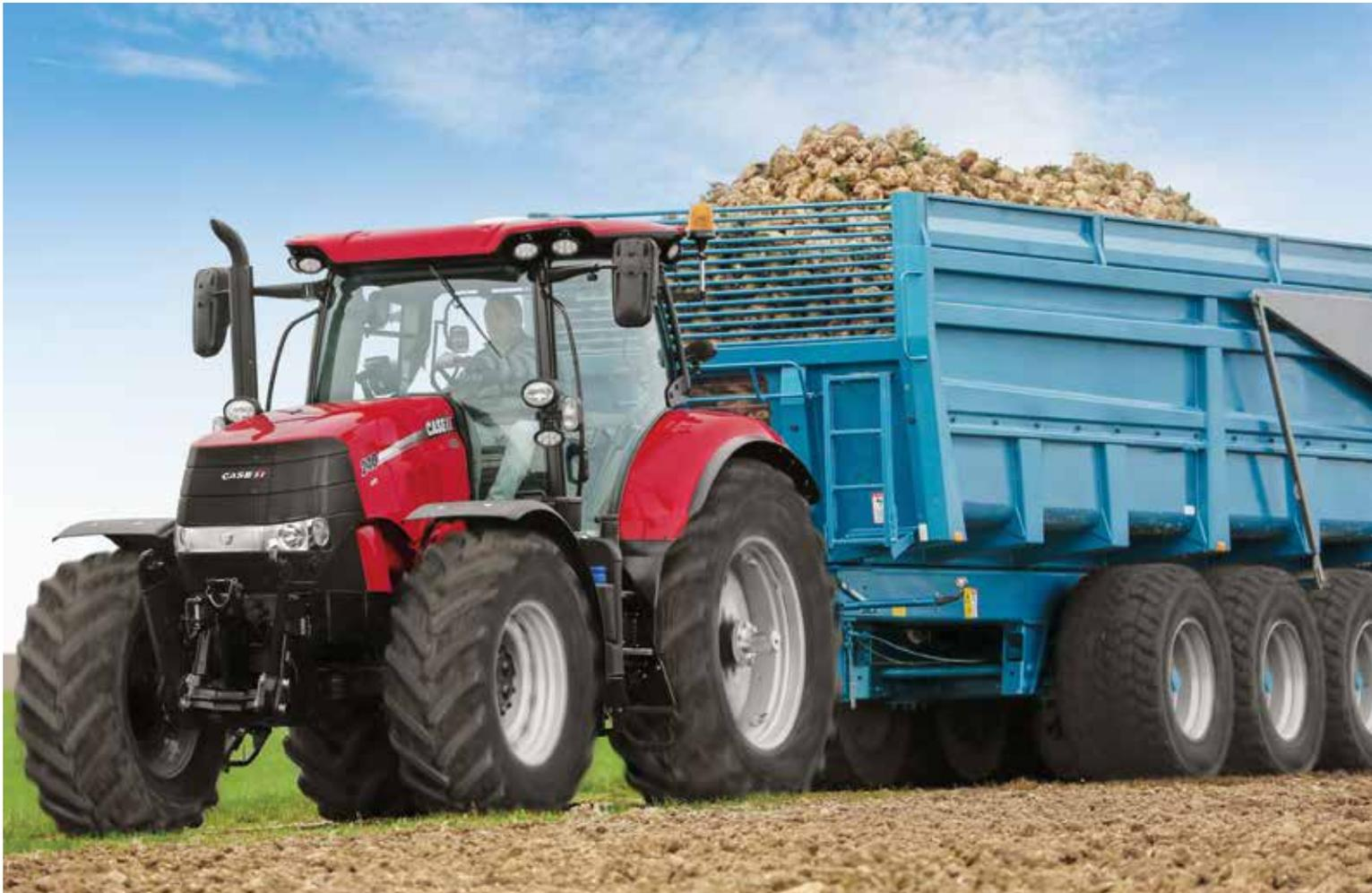
Uno dei fiori all'occhiello dei nuovi trattori Puma è rappresentato dai motori a sei cilindri potenti e dai consumi ridotti di carburante. In questo caso vengono impiegati motori NEF da 6,7 litri di FPT Industrial. Il modello di punta, il Puma 240, dispone di una potenza nominale di 240 CV.
