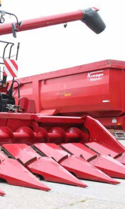
Rainer Uckelmann (in alto a sinistra) ora si è messo in proprio fornendo il servizio di raccolta dei tutoli di mais. La mietitrebbia è equipaggiata con una testata da mais portata anteriormente e di un sistema di raccolta per il tutolo nella parte posteriore.
