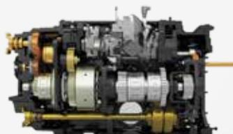
Potete scegliere tra la collaudata trasmissione Full Powershift o la trasmissione a variazione continua che fa del Magnum™ CVX una macchina assolutamente polivalente.
