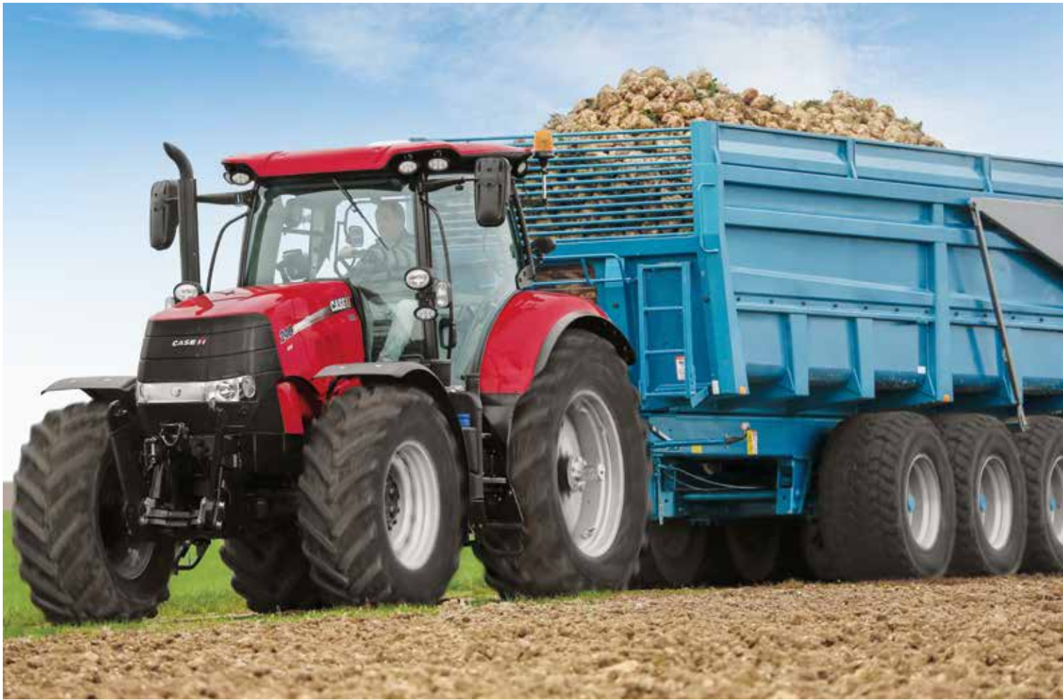
Een topkenmerk van de nieuwe Puma-tractors zijn de zes-cilinder motoren die zich onderscheiden door hun hoge prestaties en zuinige brandstofverbruik. Het betreft 6,7 liter NEF motoren van FPT Industrial. Het topmodel, van de Puma 240, beschikt over een nominaal vermogen van 240 pk.
