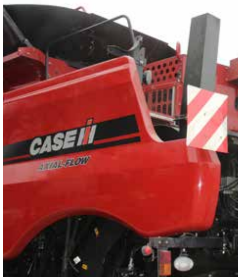
Poplon jest przenoszony w górę przez dodatkowy kanał (czarna skrzynia na zdjęciu) do zbiornika. Po opuszczeniu zbiornik znajduje się nad wałem.
