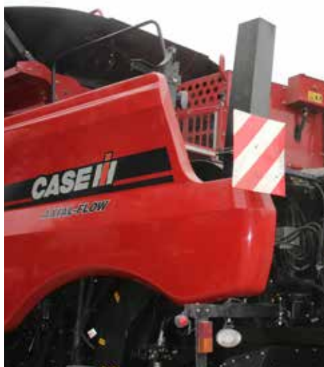
Majshalmen, hvor blade og andre småemner er fraserteret, ledes op til kassen via den sorte kasse (vist på billedet), hvorefter det kan tippes over i en vogn, hvor kanten ikke er højere end 4,5 meter.
