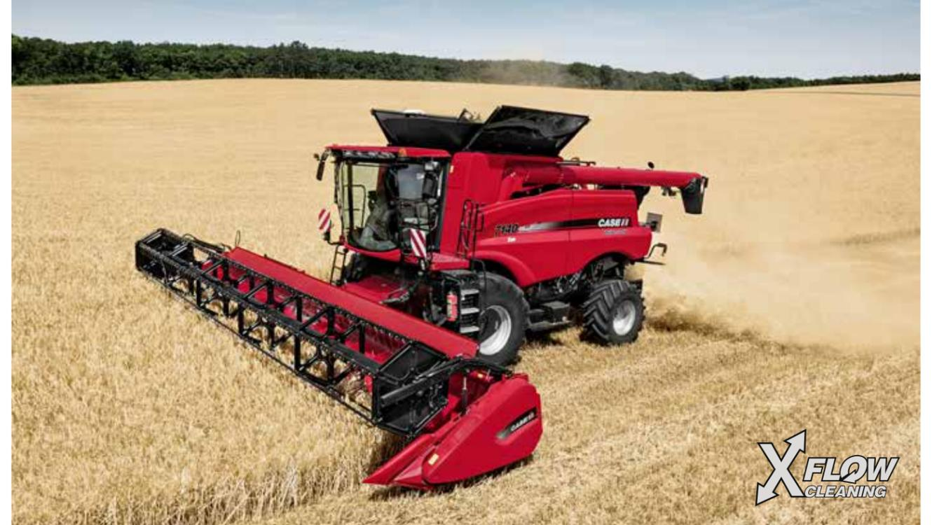
und Überkehr erleichtern auf der rechten Seite den Zugang zu dem Rotor, und der verstellbare Auslauf des Abtankrohrs sorgt für das stressfreie Befüllen der Transportfahrzeuge. „Zusätzlich ermöglichen weitere Detailverbesserungen nicht nur eine bessere Strohqualität bei der Ablage im Schwad, sondern auch eine bessere Häckselqualität und Verteilung in dem Fall, dass das Stroh auf dem Feld verbleibt“, erläutert von Eckardstein.
