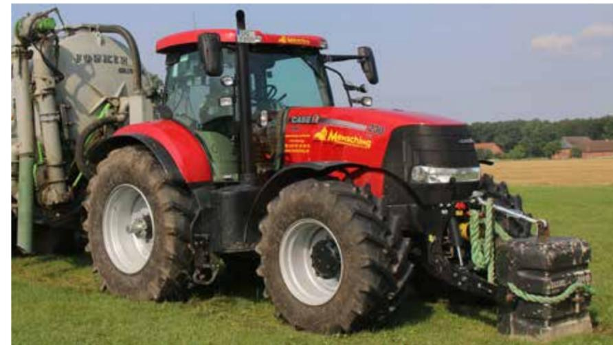
Als sehr praxisorientiert hat sich auch die aktive Stillstandsregelung erwiesen. Sie hält bei Bedarf Traktor und Anhängelast in jeder Steigung – auch ohne Betätigung der Bremsen im Stillstand. Dies ist ein deutliches Sicherheitsplus.
